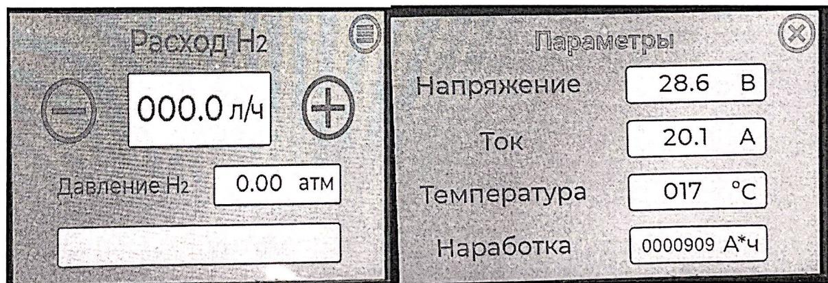
Рис.3 Сенсорная панель управления генератором водорода
