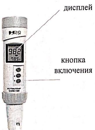
Рис. 7 Анализатор pH, окислительно-восстановительного потенциала (ОВП) и температуры жидкости
